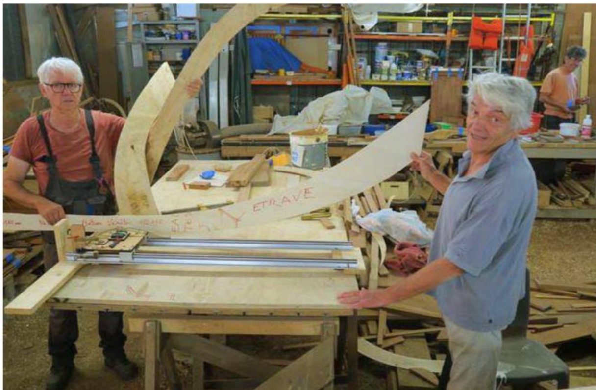
La fabrication des gabarits pour tailler les éléments de la coque dans des branches de chêne tors. Mor ErWenediz.56
